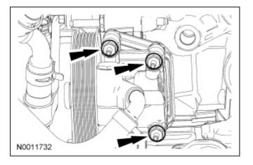
22. Install the wiring retainer on the power steering stud bolt.
